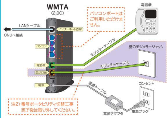
注1) ONUのLAN2ポートはIP電話サービス専用ポートです。パソコンやネットワーク機器を接続してもインターネット接続はできません。TAの電話回線ポートのモジュラーケーブル(NTT回線)は番号ポータビリティ切替工事完了後は取り外していただくことをお奨めいたします。誘導雷がモジュラーケーブル(NTT回線)を伝わって通信機器(TA)が故障・火災・感電の原因となることを防ぐ効果があります。
